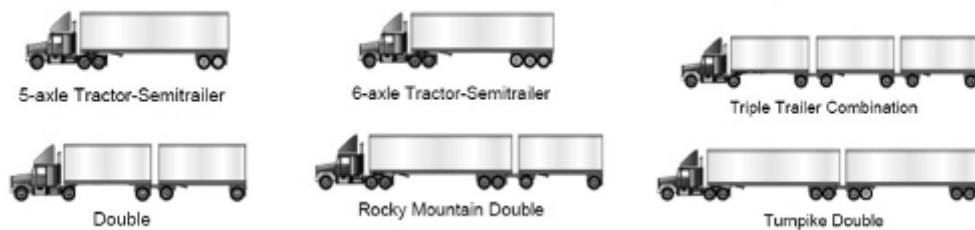
图 2 六种不同结构组成集装箱运输车辆
